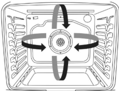
Durant la cuisson ou le rôtissage par convection, les éléments de cuisson au four, cuisson au grill et de convection s'allument et s'éteignent par intermittence tandis que le ventilateur fait circuler l'air chaud.
